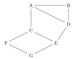
Le protocole RIP permet de construire les tables de routage des différents routeurs, en indiquant pour chaque routeur la distance, en nombre de sauts, qui le sépare d'un autre routeur. Pour le réseau ci-dessus, on dispose des tables de routage suivantes :
