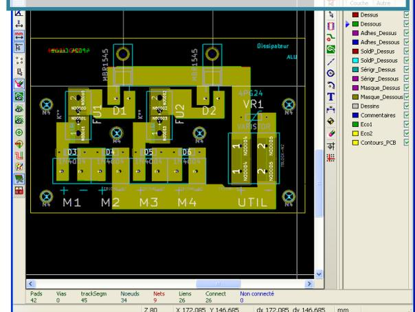
**Logiciel de routage de cartes électroniques, ( IUT de Grenoble PCBnew ).**
